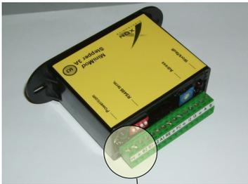
Il dispositivo va alimentato con una tensione continua da 10 a 34 volt. Il consumo di corrente è di 150 mA per il solo dispositivo, più la corrente erogata al motore (fino a 6A di picco).
