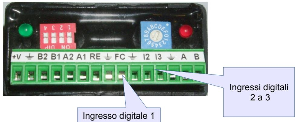
I tre ingressi digitali (FC, I2, I3, anche chiamati X1..X3) hanno una impedenza d'ingresso di 5 Kohm e un circuito di protezione per i componenti interni. Devono essere pilotati con una tensione positiva per attivarli (lasciati liberi, sono in stato *off*). Le funzioni degli input sono le seguenti:
